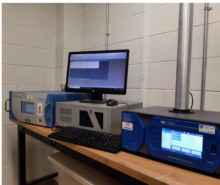
Légende : Matériel de surveillance de la qualité de l'air. Un appareil de surveillance de l'ozone (O 3 ) (à gauche) et un appareil de surveillance des matières particulaires (PM 2,5 ) (à droite)
